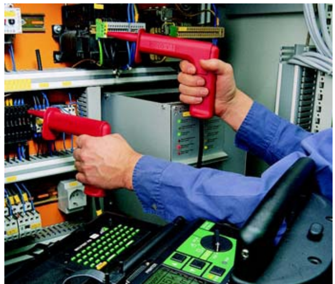
Metramachine 204 100% elektrische veiligheidstesten uitvoeren conform NEN-EN 60204-1 is noodzakelijk! Metramachine 204 in bedrijf op een controleafdeling van een productiebedrijf van elektrische besturingspanelen.
